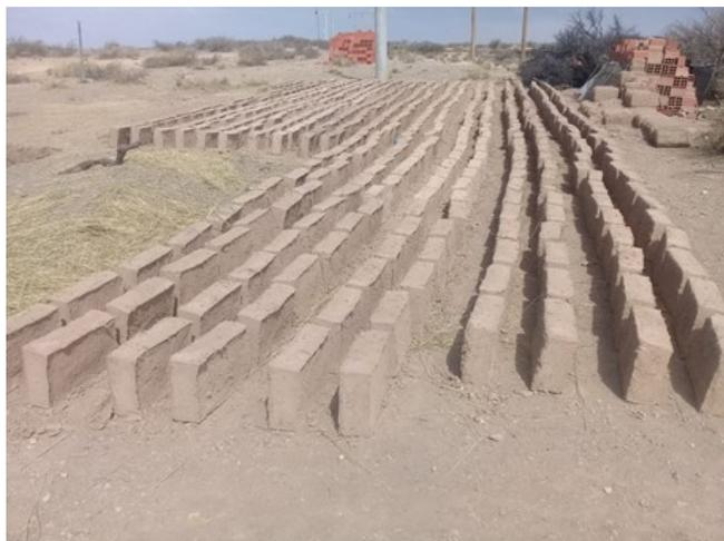
← "Adobes", briques de terre crue, réalisées par les membres de la communauté pour la construction.
